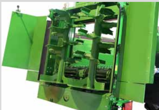
DEFLEKTOREN UND VERTIKALER SCHNECKENDREHADAPTER
