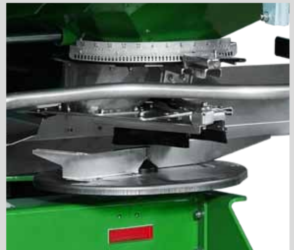
SÄMASCHINE MIT SICHTBARER SKALA UND BÜRSTEN
